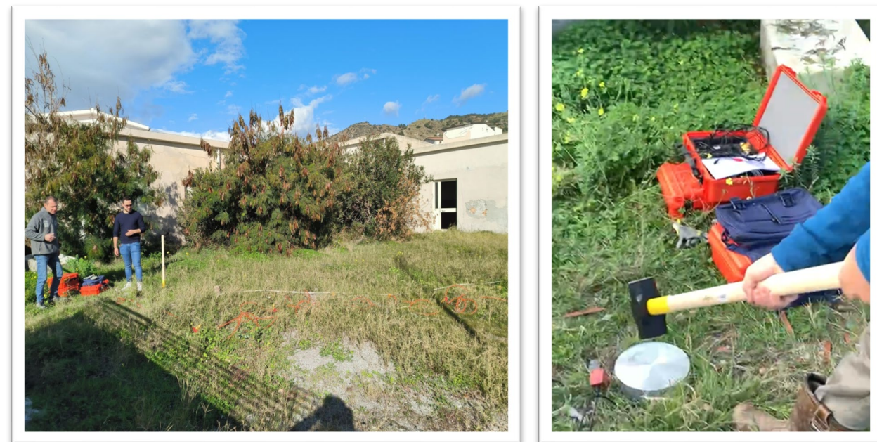
Esecuzione di prove MASW nel sito di Palizzi Marina – UniRC lab. Geotecnica
