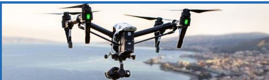
Acquisizione fotogrammetrica zenitale e obliqua tramite Drone
